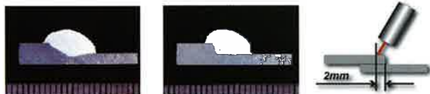
AHサンアーク35 アルゴン A5052 t2mm 80A 16~21V 40cm/min
