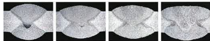
アルゴン AHサンアーク33 AHサンアーク35 AHサンアーク37 A5083P-O t:10mm 300~350A 50cm/min
